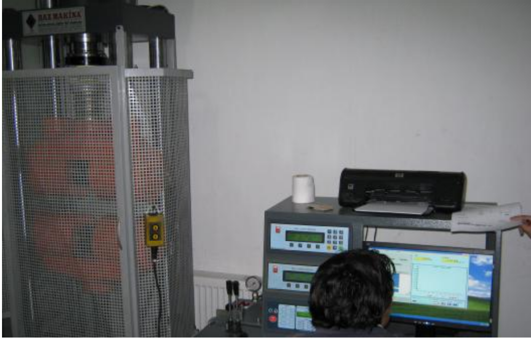
Şekil 4.15. Tek eksenli basınç deneyi makinesi.
