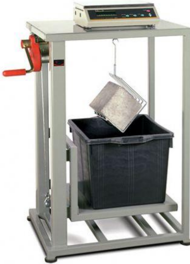
Şekil 3.14. Özgöl ağırlık deney düzeneği.
