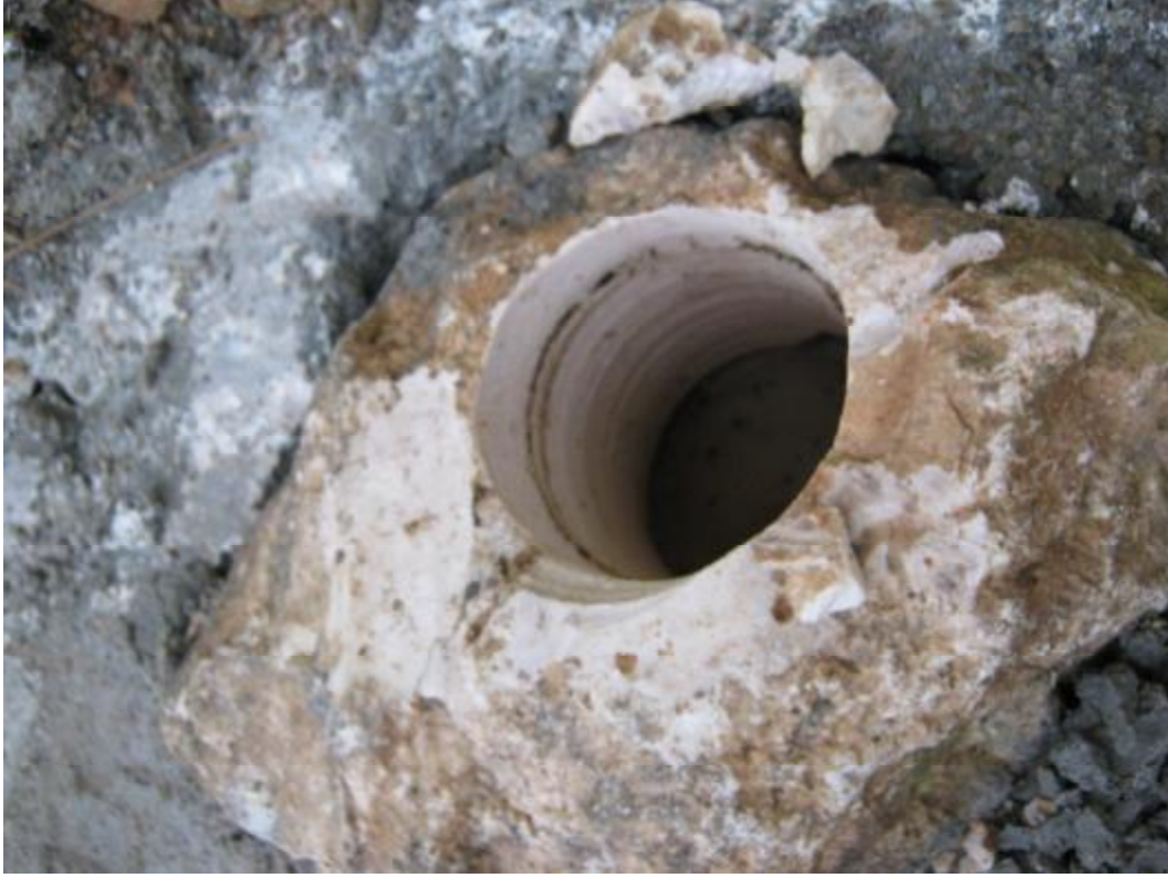
Şekil 4.14. Laboratuarda blok numunelerden karot numunesi alma.
