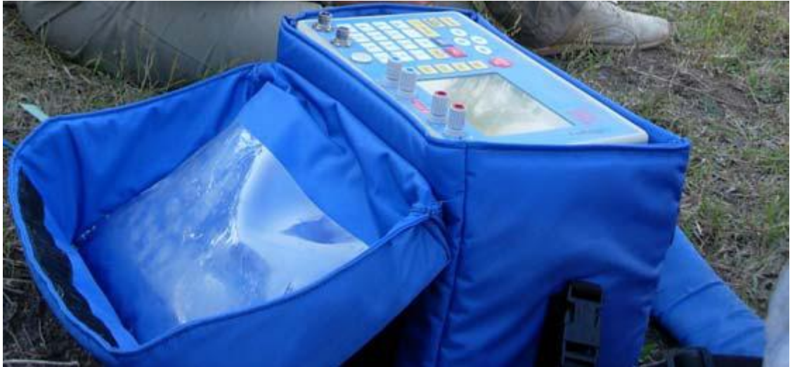
Şekil 7.37. ARIS Scintrex çok kanallı öz direnç aleti
