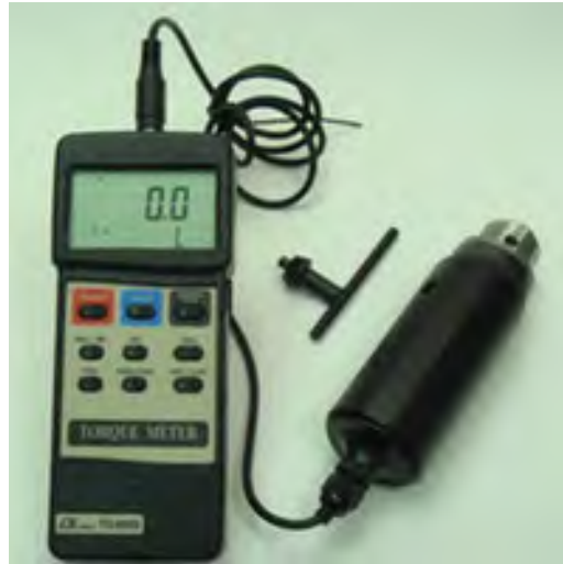
řekil 3.3. Lutron TQ-8800-dijital tork ölüm cihazı
