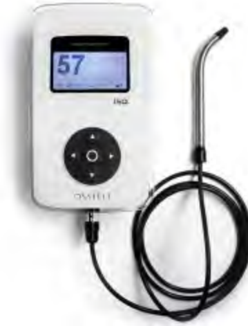
Şekil 3.4. Osstell Mentor- rezonans frekans (RF) ölçüm cihazı
