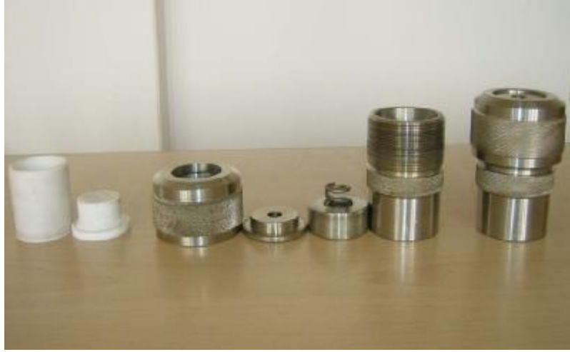
Şekil 1.11. Sırasıyla Teflon Reaksiyon Kabı ve Kapağı, Basınca Dayanıklı Asit Sindirme Kabı ve Parçaları, Deneye Hazır Kapalı Parr Acid Reaktör.
