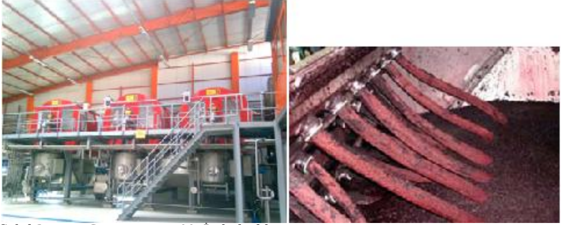
Şekil 3.2. BUCHER HPX 5005İP hidrolik pres ve iç görünümü
