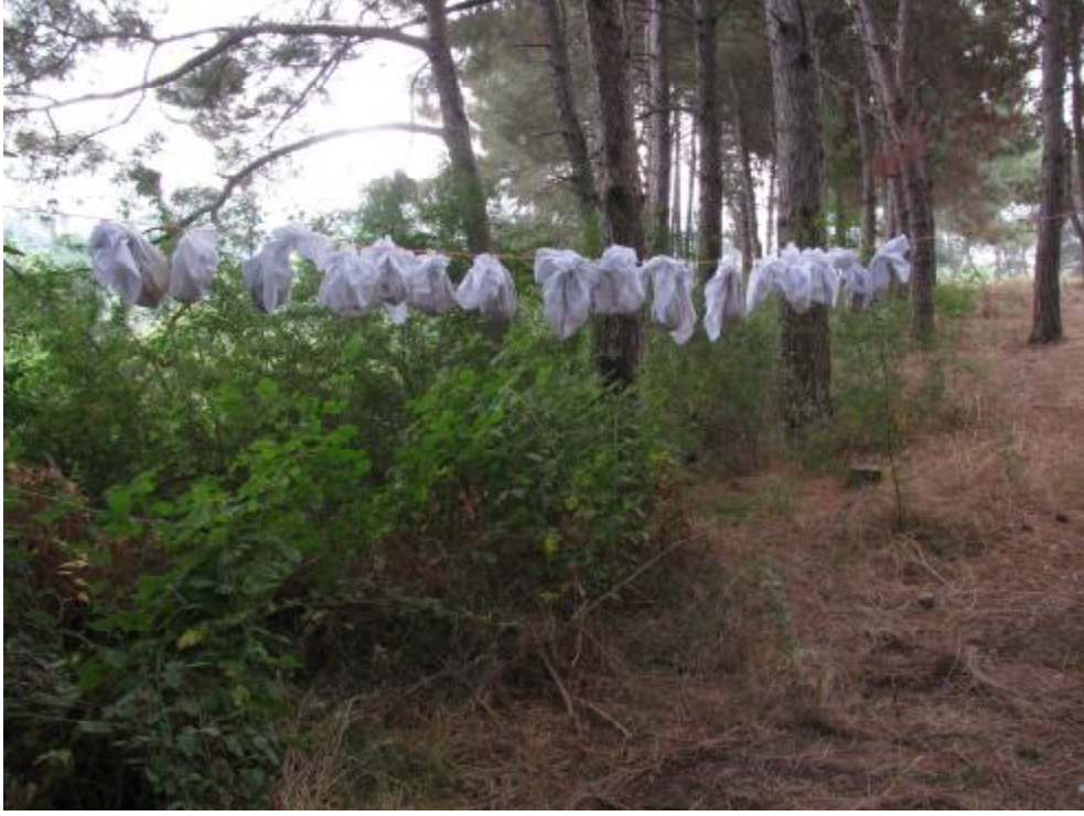
Şekil 3.10. Yüzdürme işlemi sonrası örneklerin kaput bezlerinde kurutulma işlemi
