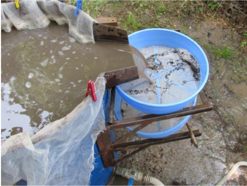
Şekil 3.7. Yüzdürme tankına sinek telinin mandallarla tutturulması ve oluktan karbonlaşmış materyallerin akışı
