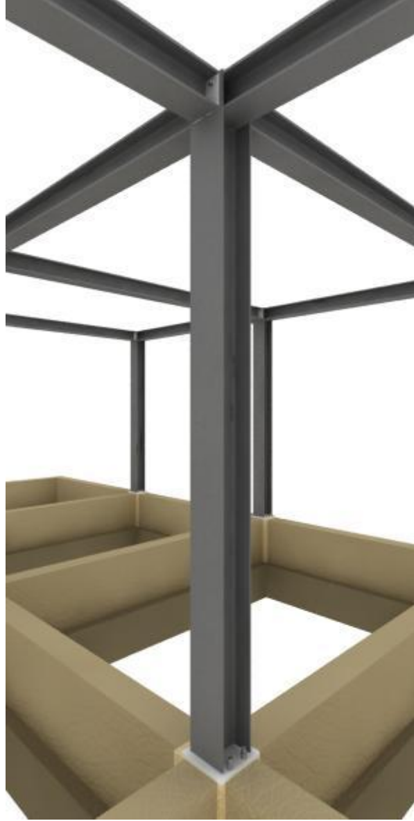
EK 20. elik Konstrüksiyon Kolon Detayı Ü Boyutlu Grseli
