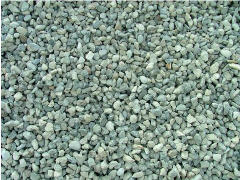
Őekil 19. Dođal dere agregasının kırma-öđütme işleminin sonrasında kırmataő haline getirilmiő durumu
