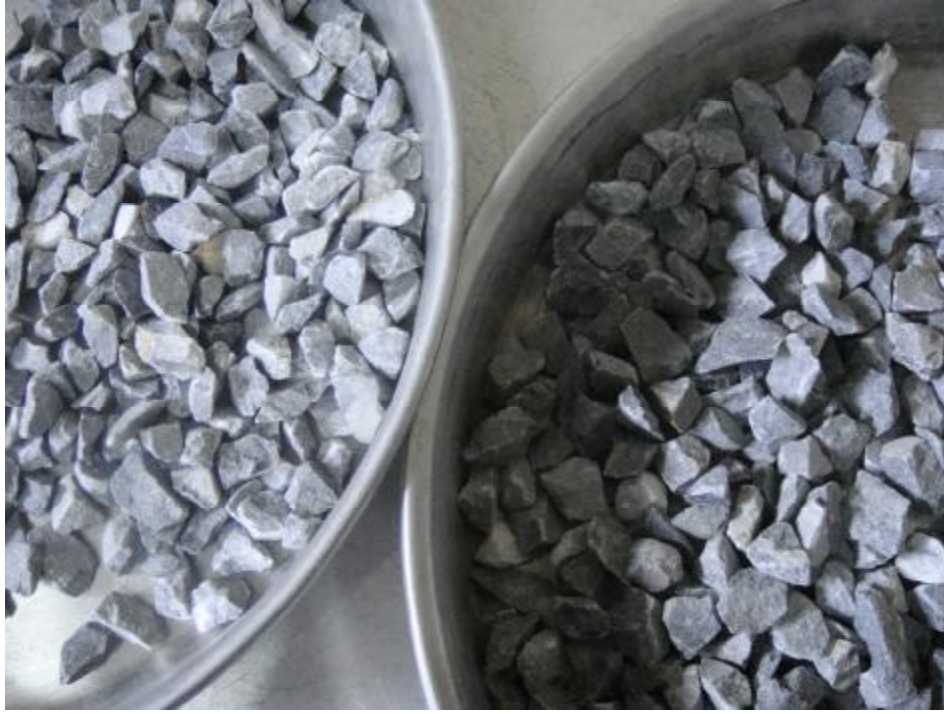
Şekil 17. Kireçtaşın malzemenin kırmataş haline getirilmiş sonuç durumu
