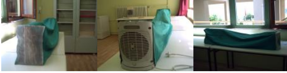
a . b . c. Foto 4.6. a. Kumaş içerisinde pres yerleşimi b. Karşı tarafa konulan fan c. Sistem
