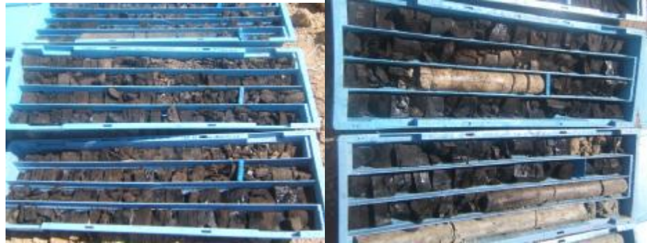
Şekil 4.17. Hotamış Formasyonu içerisindeki linyitli seviyelere ait karot görünümleri.
