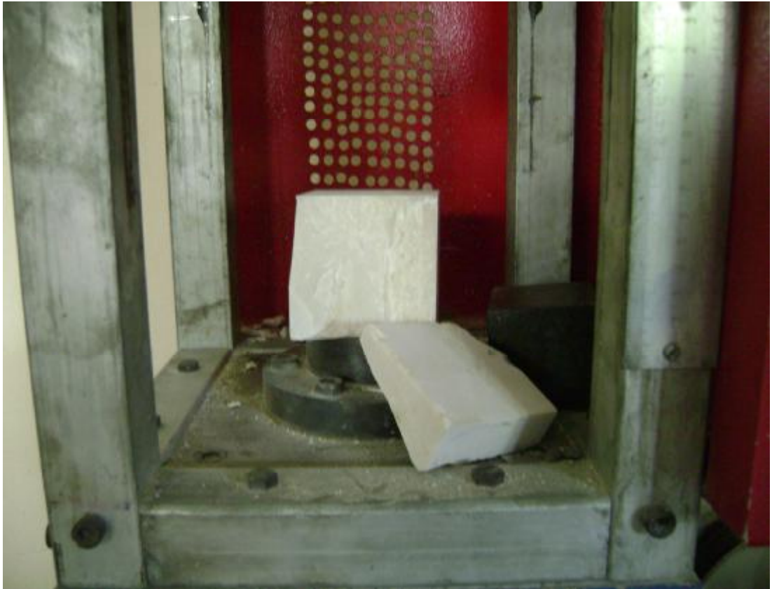
Şekil 3.15. Darbeye Maruz Kalan Numunenin Deneyden Sonraki Görüntüsü
