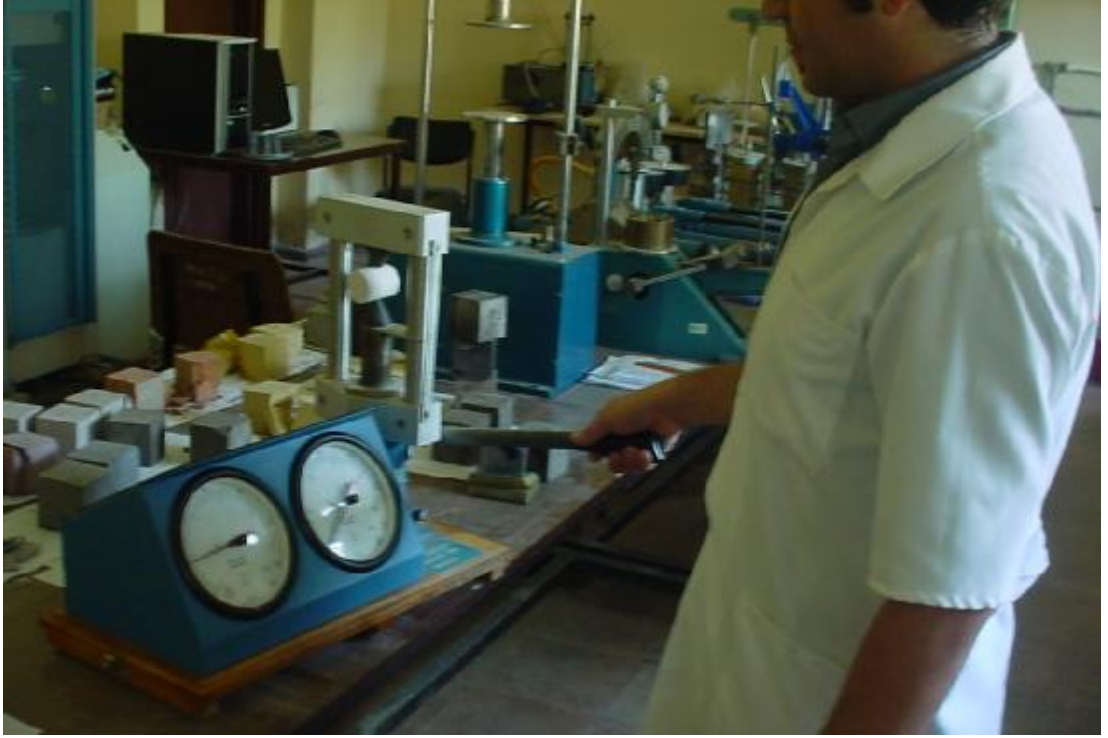
Şekil 3.18. Nokta Yük Deneyi Aleti ve Numunenin Görünümü
