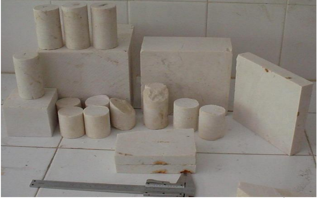
Şekil 3.9. Burdur Yeşilova Bölgesinden Alınarak Fiziko Mekanik Deneyler İçin Hazır Hale Getirilen Numunelerin Görüntüsü
