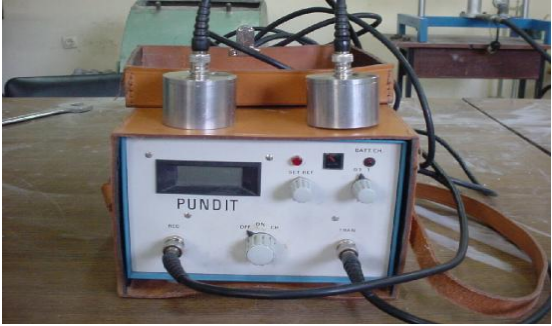
Şekil 3.11. Sonik Hız Ölçmede Kullanılan Pundit Aleti
