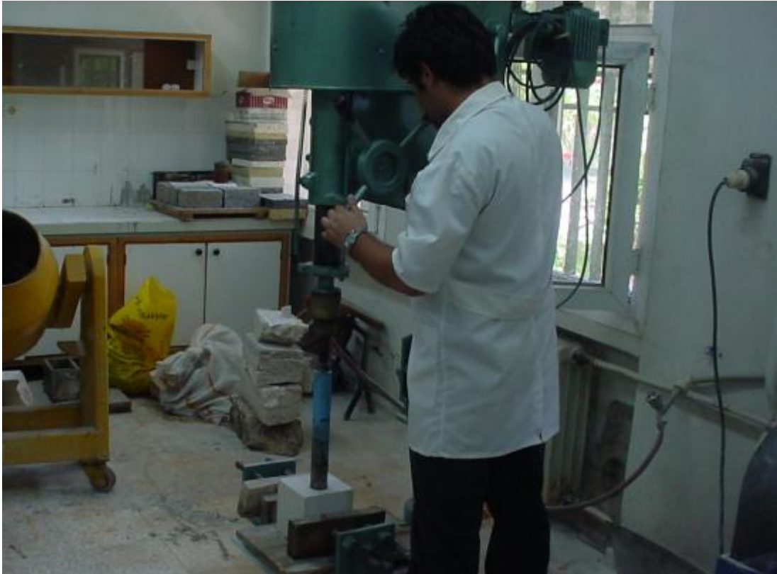
Şekil 3.8. Kayaç Numunelerinden BX Çapında Karotun Alınışı
