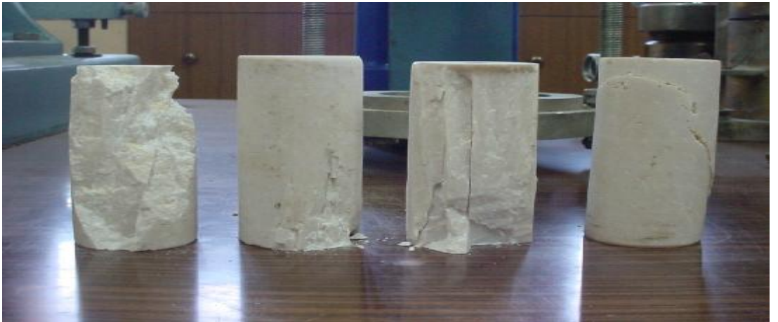
Şekil 3.13. Numunenin Basınç Deneyinden Sonraki Görüntüsü
