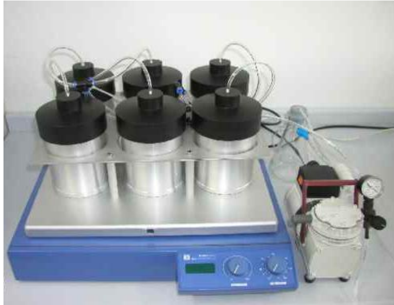
 ekil 3.6 Vakumlu dehidratasyon ve infiltrasyon  nitesi
