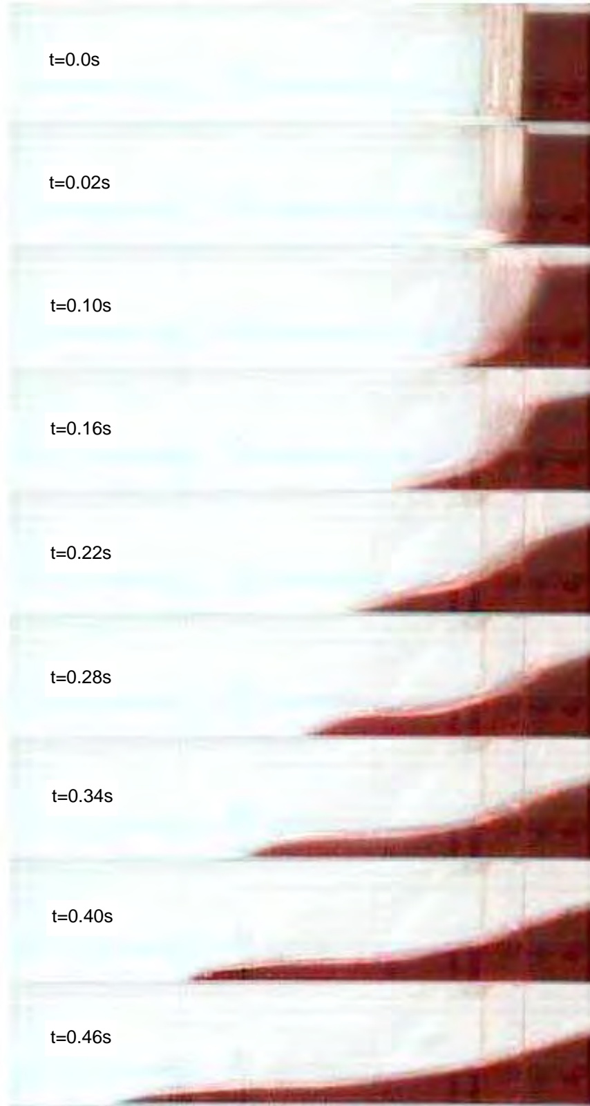
Şekil 5.9. Kuru kanalda baraj yıkılması dalgasının başlangıç aşamalarındaki deney görüntüleri
