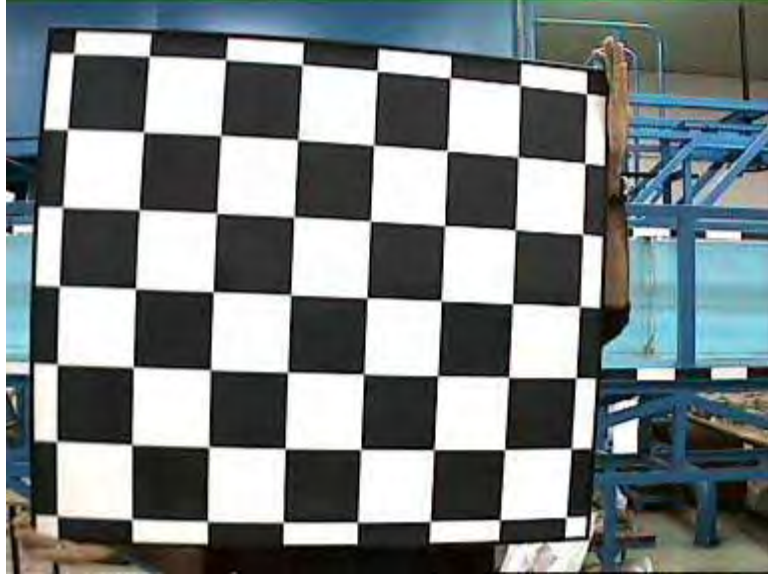
Şekil 4.5. Kalibrasyon panosu (Bombeli görünümde)
