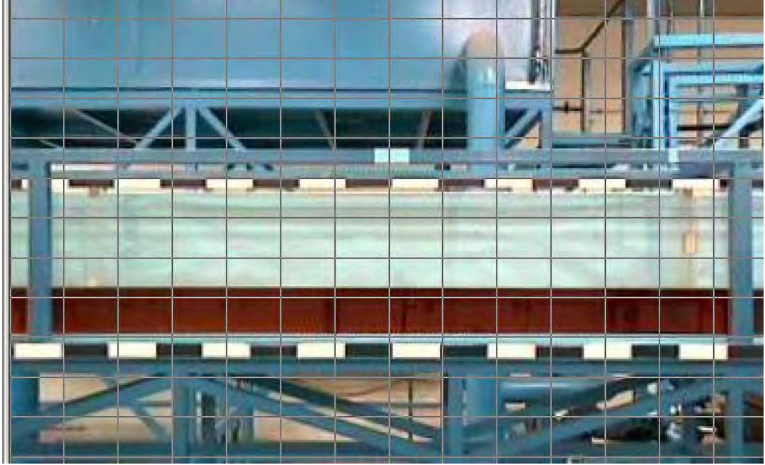
Şekil 4.12. Görüntülerin ızgaralar kullanılarak yatay hale getirilmesi
