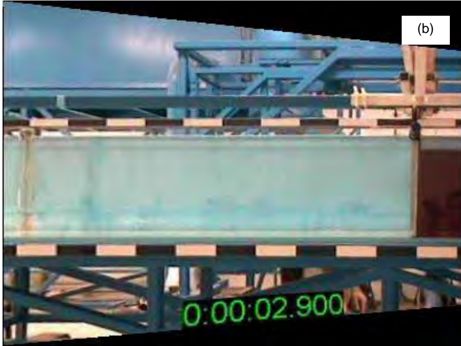
Şekil 4.11. Görüntünün perspektif kalibrasyonu a) perspektif görünüme sahip ham görüntü b) kalibre edilmiş düzlem görüntü
