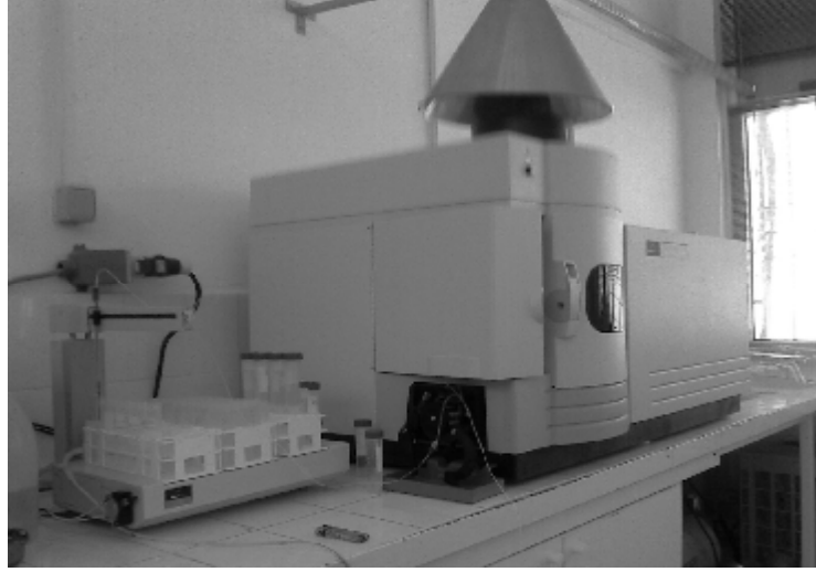
Şekil 3.11. Perkin Elmer Marka Optima 2100 DV OES (Optical Emission Spectrometer)Cihazı
