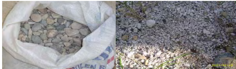
Şekil 3.8. Kum-Çakıl Ocağından Temin Edilen Çakıl ve Tufün Görüntüsü
