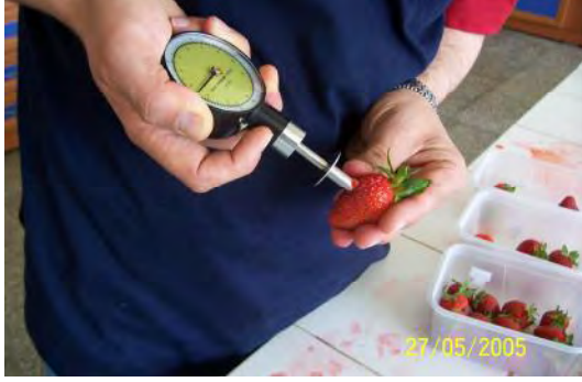
Şekil 3.13. Meyve Sertliğinin Penetromotre ile Belirlenmesi
