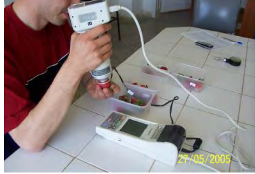
Şekil 3.14. Meyve Dış Renginin Kromometre ile Belirlenmesi
