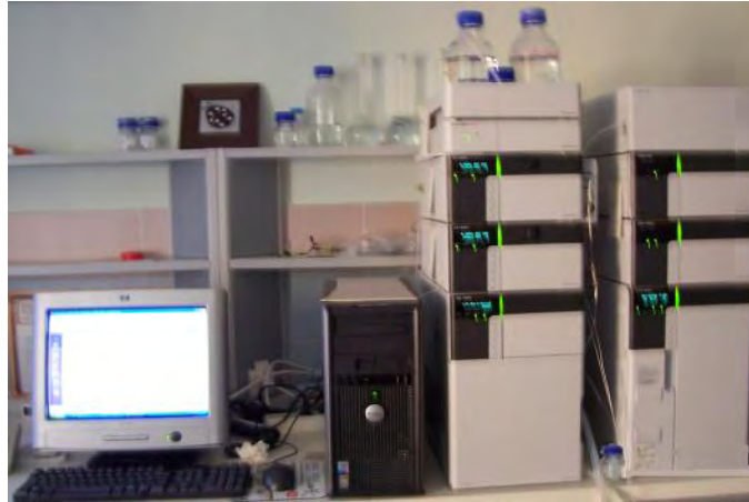
Şekil 3.18. Ellajik Asitin Shimadzu WP HPLC Cihazı ile Belirlenmesi
