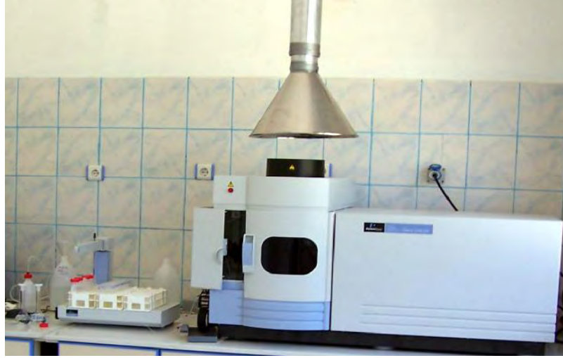
Şekil 3.10. Denemede kullanılan Perkin-Elmer 2100 ICP cihazı
