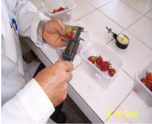
Şekil 3.11. Meyve boyutlarının Dijital Kumpas ile Ölçülmesi
