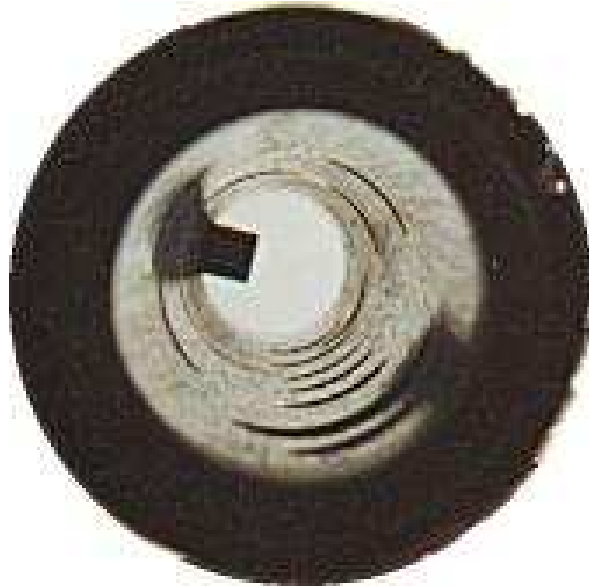
Resim 64: Klarinet gövdesinin pürüzsüz içyapısı ve register ses deliğine yerleştirilmiş borucuk örneği
