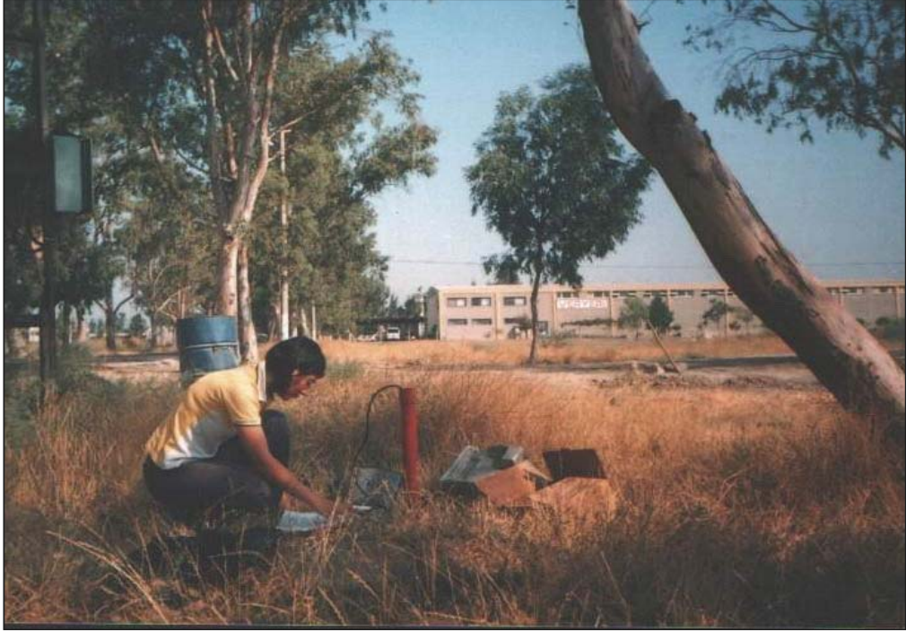
Şekil 3.1. Gözlem Kuyusundan Taban Suyu Derinliğinin Ölçümü
