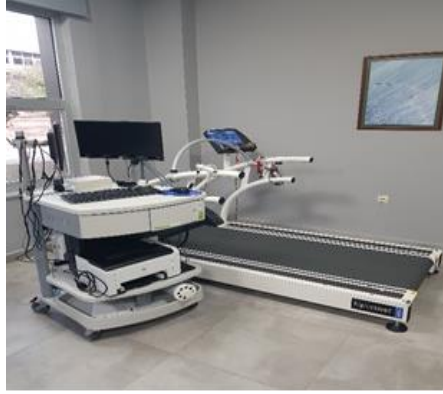
řekil 3.7. Elektrik motorlu kořu bandı ve gaz analizörü (Quark-Omnia; Cosmed, Rome, Italy)
