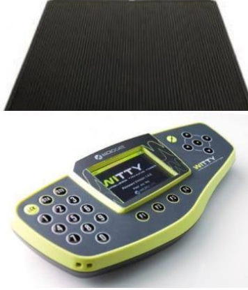
Şekil 3.11. Temasa Duyarlı Hassas Sensörler İçeren Sıçrama Matı (Witty timer, Microgate, Bolzano, Italy)
