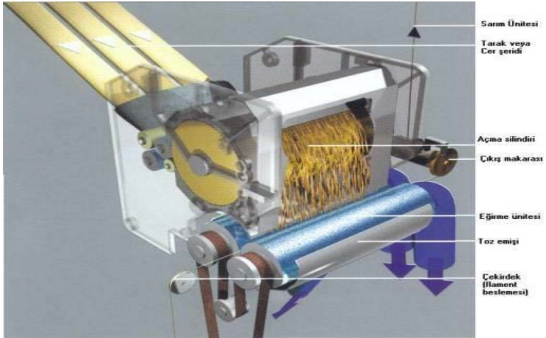
Şekil 3.4. Dref 2000 makinesinde özlü iplik üretimi (Küçük, 2010).
