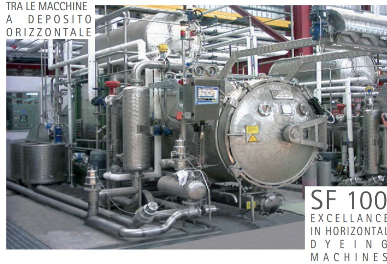
Şekil 5.5. Mcs jet 100 Kg kapasiteli boyama makinası ( http://www.mcsgroup.it/ )
