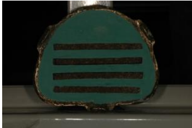
Şekil 3.4. Mantar şerit ana modellerin alçı mufladaki görüntüsü
