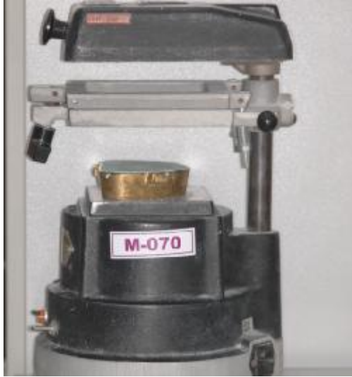
Şekil 3.5. Vakum termoform cihazı
