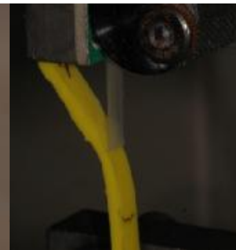
Şekil 4.4. P/TipA/A335 soyulma görüntüsü
