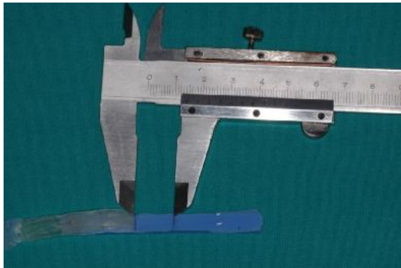
Şekil 3.13. Soyulma mesafesi ölçümü
