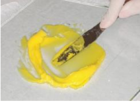
Şekil 3.7. Silikon elastomerlerin hazırlanışı
