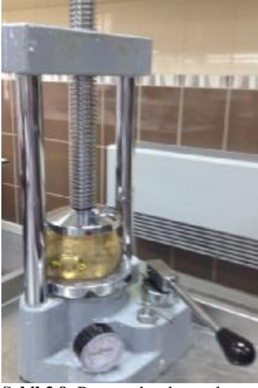
Şekil 3.9. Basınç altında preslenen mufla
