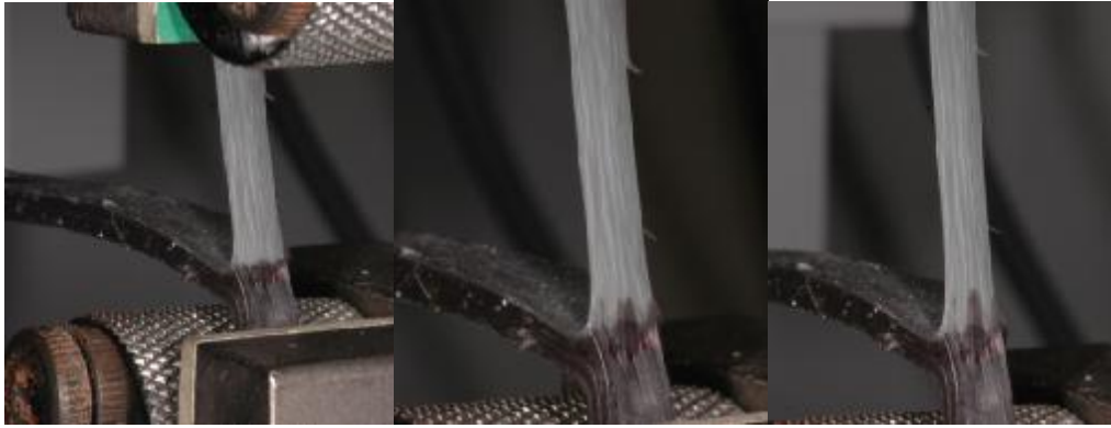
Şekil 4.2. YP/TipA/A304 soyulma görüntüsü.
