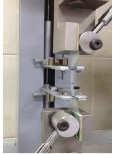
Şekil 3.17. Çekme dayanımı testinin uygulanması
