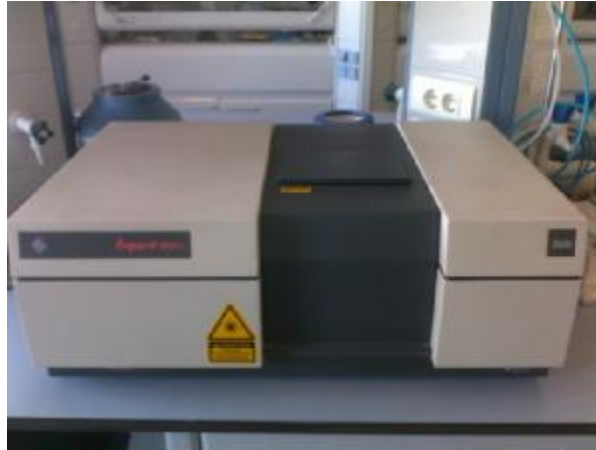
Şekil 3.1. FTIR (Fourier Transform Infrared) spektroskopisi
